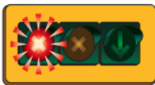
控制信号:置于车道上方，指示哪条车道可供驾驶。在这里: 红色=不要在右车道行驶
